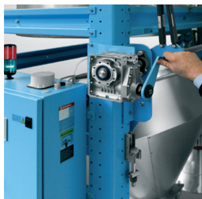
Assisted cone opening. Apertura assistita del cono.
