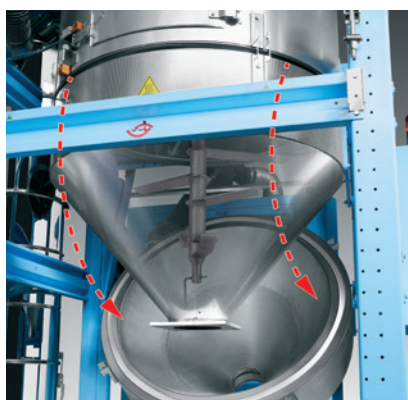
Easy openable cone system. Sistema rapido apertura cono.
