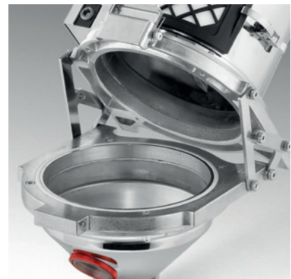
Quick opening hinge. Cerniera per apertura rapida.
