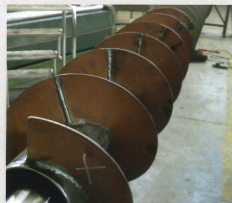
Spirale hardox ad elevata resistenza all'usura Hardox spiral with high resistance to wear Spirale hardox à grande résistance à l'usure
