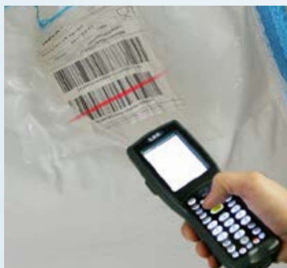
Bar code material recognizing. Riconoscimento materiale con bar code.
