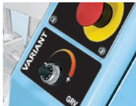
VARIANT Control panel with rotor revolution speed knob. Comandi variatore dei giri rotore.
