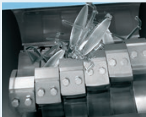
MULTIBLADE Grinding of molded items. Macinazione di pezzi stampati ad iniezione.
