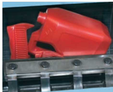
UNIBLADE Bottles and hot sprues grinding. Macinazione di flaconi e materozze calde.
