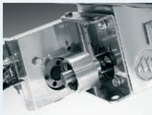
Extraction system of dosing screws. Sistema di estrazione rapida delle viti di dosaggio.
