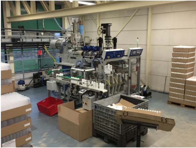
Een GDK blaasmachine type GM5002.E bij Flestic in Dronten.
