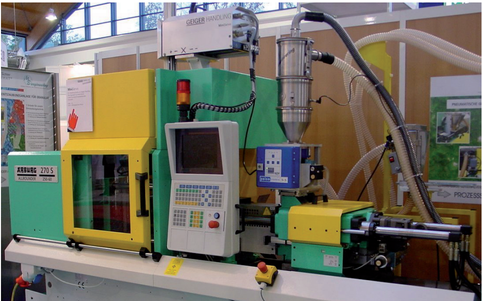
Digital Compact 50 direkt auf Spritzgussanlage montiert.
