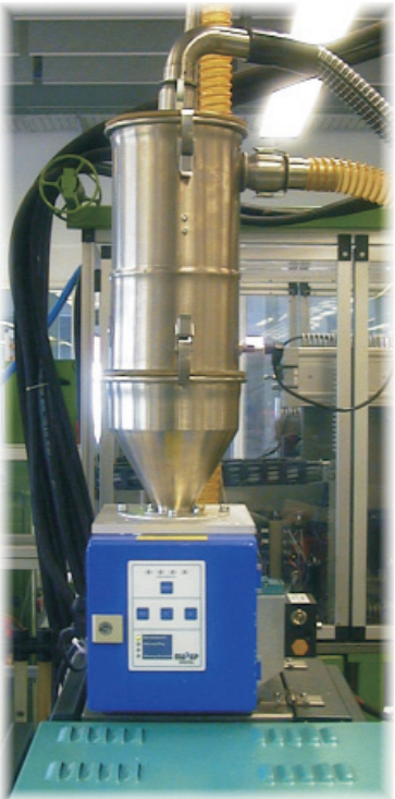
Digital Compact 50 zur Kontrolle von Kunststoffgranulat mit direkt montiertem Silo und Vakuumfördereinrichtung.
