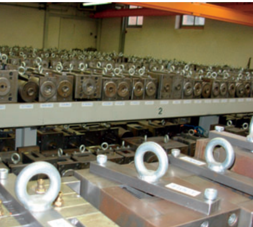
Moba beschikt over 1500 actieve matrijzen die worden gebruikt bij de klantspecifieke productie van kunststof onderdelen.
