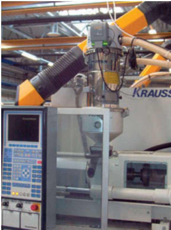
Geïsoleerde Piovan machinetrechter met hopperloader op de machine.
