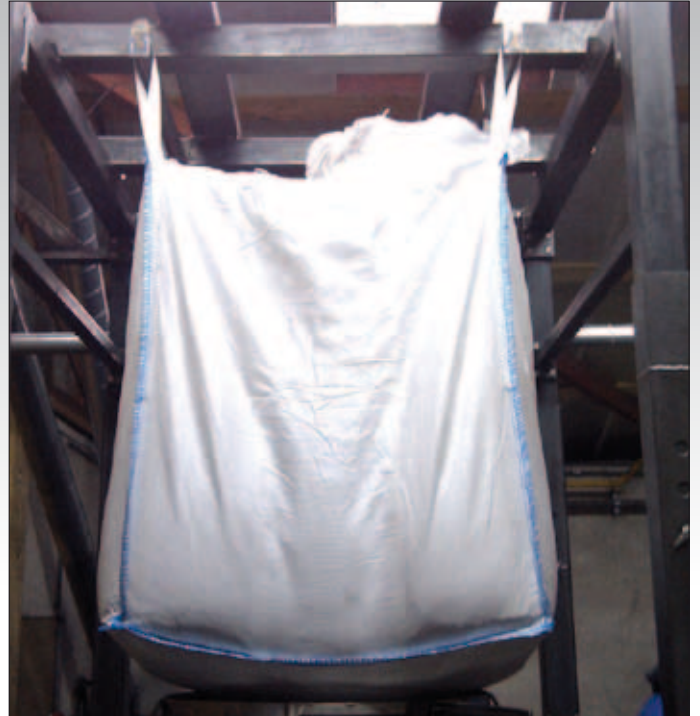
Losbunker met big bag gevuld met actief kool
